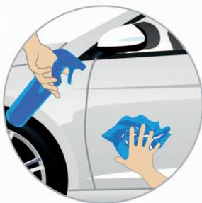
Reinigen und entfetten Sie den Untergrund gründlich. Dazu eignet sich Wasser mit ein wenig Spülmittel. Achten Sie darauf, dass sich keine öligen oder klebrigen Substanzen mehr auf der Oberfläche befinden.
