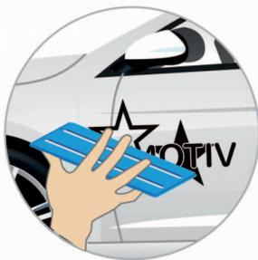
Dann legen Sie den Aufkleber auf die Oberfläche und positionieren ihn nach Ihren Wünschen. Die Nassverklebung lässt etwas mehr Spiel bei möglichen Verklebefehlern. Haben Sie die richtige Ausrichtung gefunden, rakeln Sie das Wasser, beginnend an einer Ecke, nach und nach zur Seite raus. Am Ende sollte unter der Folie keine Flüssigkeit mehr sein.
